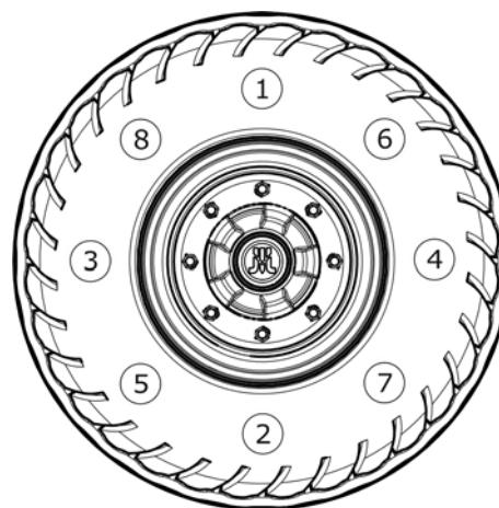
RYСУNEK 5.5 Kolejność odkręcania i dokręcania nakrętek
